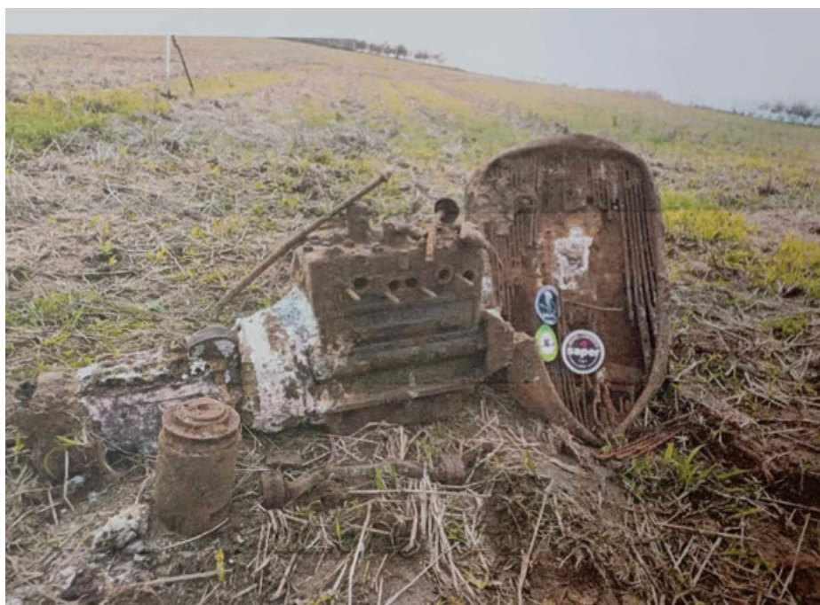
Ryc. 2. Adamów, powiat Opatów. Elementy samochodu marki Fiat model 508: blok silnika ze skrzynią biegów, prądnica, łąpa podsilnikowa, chłodnica z atrapą, drążek zmiany biegów oraz pedał gazu. Fot. za Florek 2020
