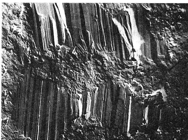
Ryc. 6. Dubno. Brama Łucka. Próbkę zaprawy wapiennej z podziemnej części wieży – struktura zwarta (powiększenie 2000 x)
