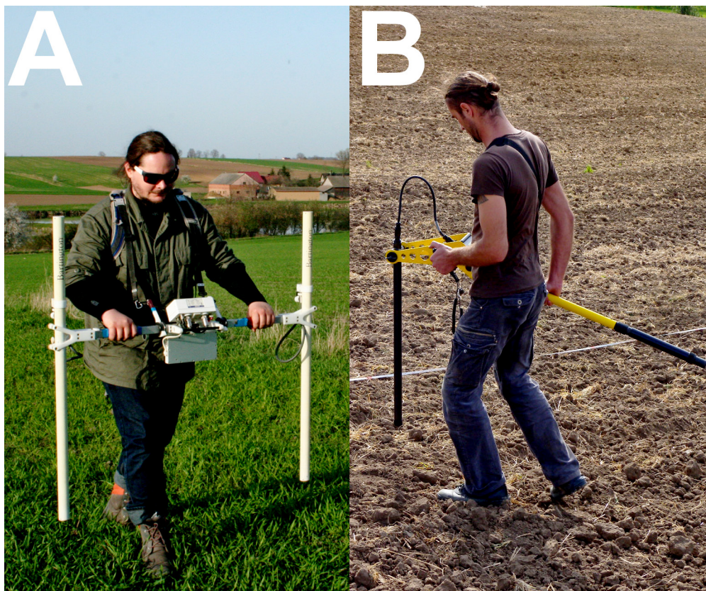
Ryc. 1. Magnetometry transduktorowe Bartington Grad601-Dual (a) oraz Foerster Ferrex 4.032 DLG (b) zastosowane podczas badań w Krzczonowicach (fot. P. Wroniecki)
